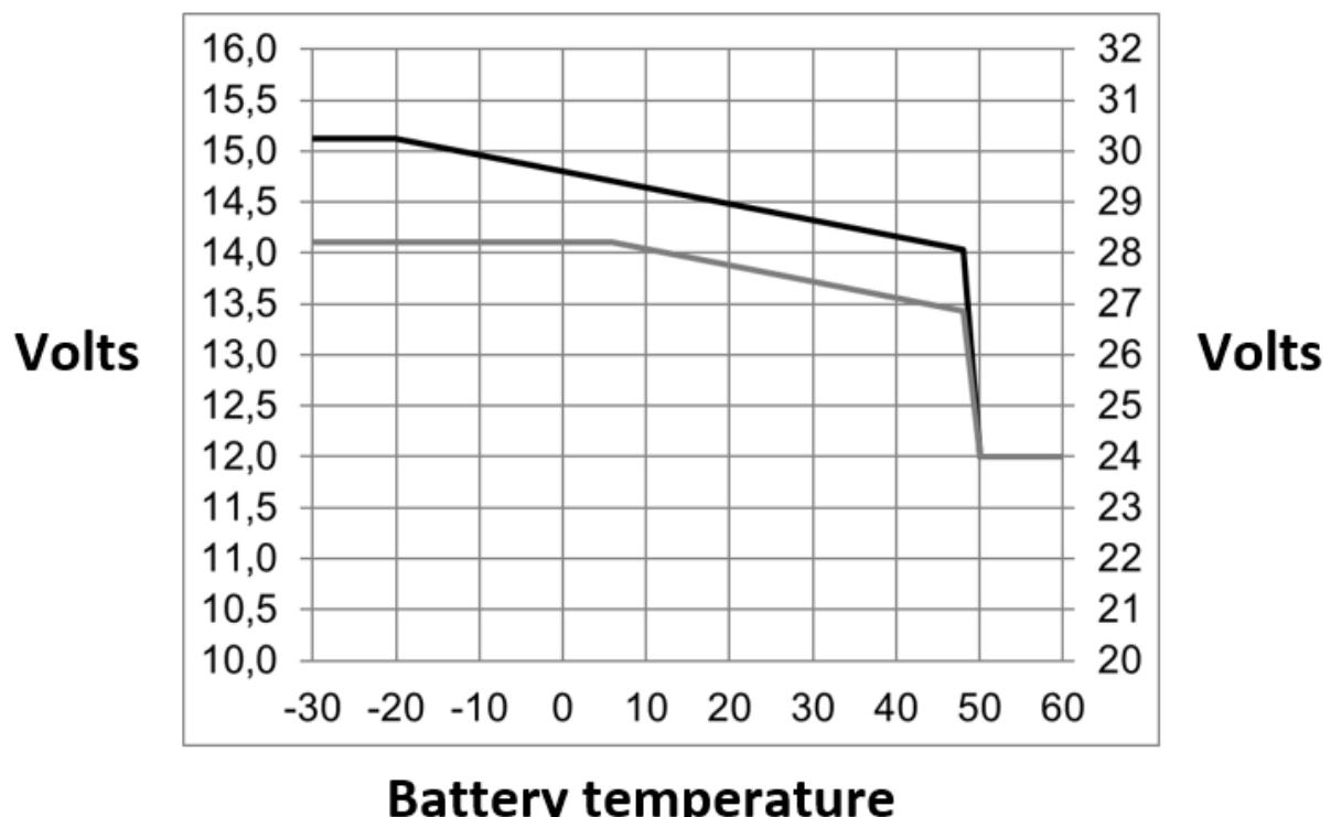
Las tensiones de salida por defecto para "Float" y "Absorption" se dan a 25 °C.
